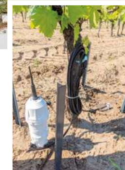
Sonde de suivi de l'humidité et de la conductivité © BRLE
